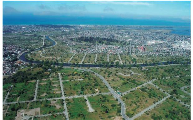
Figura 8: Las áreas más afectadas por la licuefacción han recibido la calificación de “zonas rojas” y se han demolido todas las viviendas.
