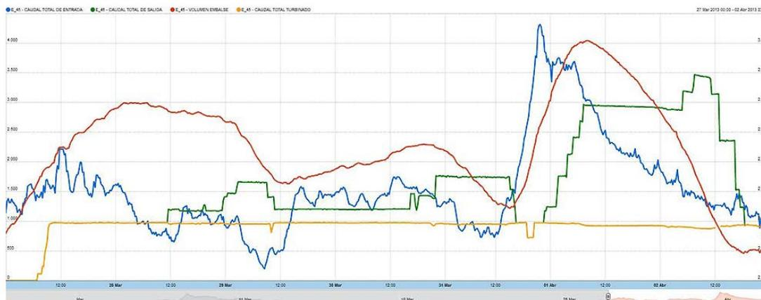
*Ilustración 6. La gestión de los embalses, junto con los sistemas de seguimiento hidrológico de las cuencas, pueden ayudar notablemente a disminuir los daños que producen las inundaciones. En el gráfico se aprecia la gestión del embalse de Alcántara (Tajo) durante un episodio de inundación. Las entradas de agua al mismo (línea azul) fueron mucho mayores que las salidas (línea verde), lo que motivó que los daños aguas abajo fuesen notablemente inferiores.*
