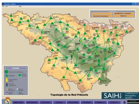
Figura 10. Esquema de la red primaria de comunicaciones.
