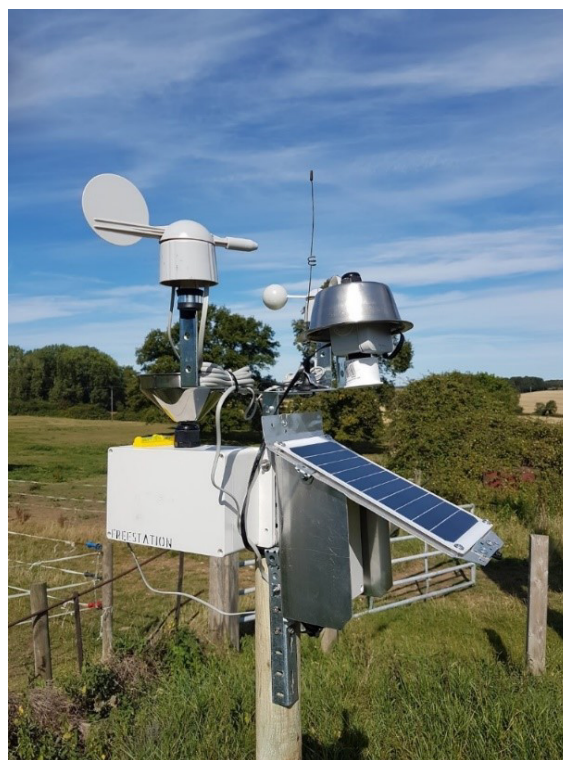
Figura 2: Imagen de una estación autónoma //Smart:River: uso de IoT para la prevención de inundaciones.
