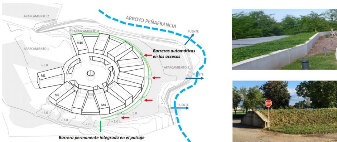
Figura 18. Caso piloto en Gijón: esquema resumen de la alternativa 2. Detalle: ejemplos de barreras permanentes integradas en el paisaje.
