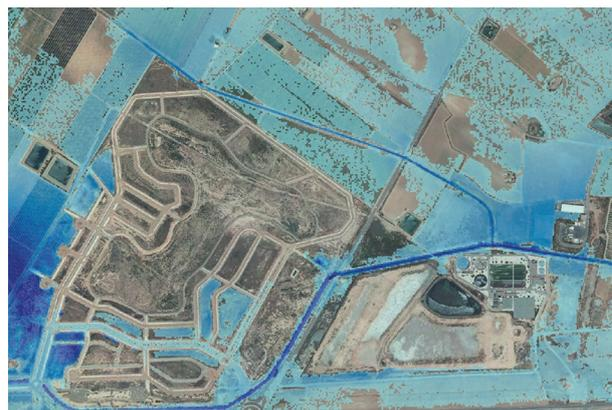
Figura 5. Ortofoto con el modelo de la CHS de calados para un periodo de retorno de 100 años (en gradación de azules), donde se aprecia que zonas que se inundaron realmente lo hicieron no por flujos sino por lluvia in situ, al tratarse de zonas aisladas con cotas inferiores al propio entorno como, por ejemplo, parcelas bajo las rasantes de los viales en zonas a medio urbanizar.
