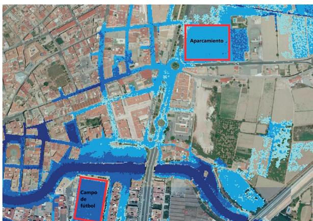
Figura 9. Ortofoto con el modelo de calados para el periodo de retorno de 50 años, resaltando en rojo el aparcamiento y el campo de fútbol que se ven en las figuras 7 y 8.
