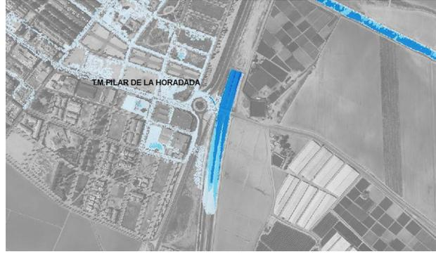
Figura 12. Vista de detalle del túnel de la AP-7, observándose su entrada sur, que queda inundado por el desbordamiento de la rambla, cuyo cauce continúa hacia aguas abajo pasando precisamente por encima del túnel. Justo a la entrada, el calado obtenido por el modelo es de 1,6 m.
