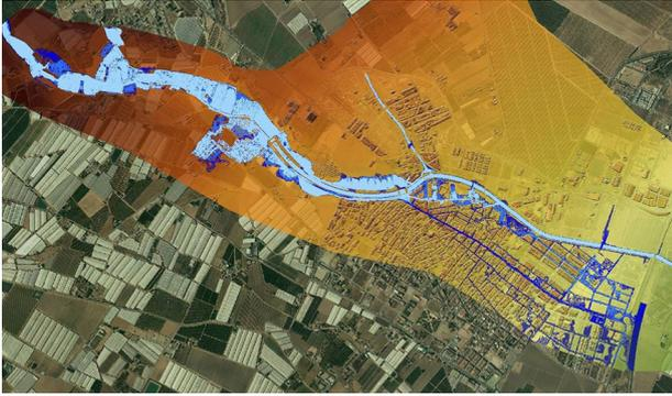
Figura 11. Ortofoto con el modelo de calados para un periodo de retorno de 500 años. La AP-7 discurre por el oeste, viéndose la entrada del túnel en el ángulo inferior derecho de la imagen.
