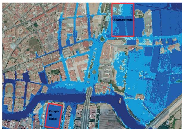
Figura 10. Ortofoto con el modelo de calados para el periodo de retorno de 100 años, resaltando en rojo el aparcamiento y el campo de fútbol que se ven en las figuras 7 y 8.
