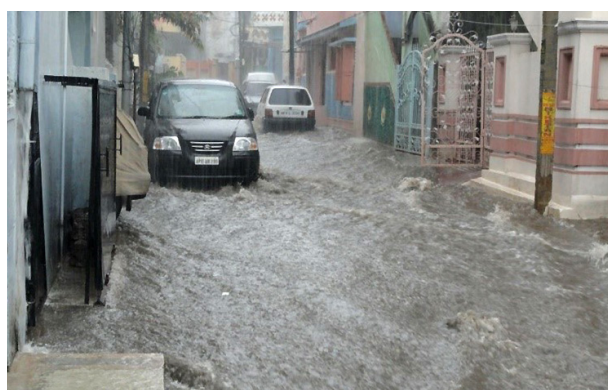
Imagen 5. Diferentes factores, como el peso o la forma del vehículo, la profundidad y la velocidad del torrente de agua, provocan que el vehículo comience a ser arrastrado.
