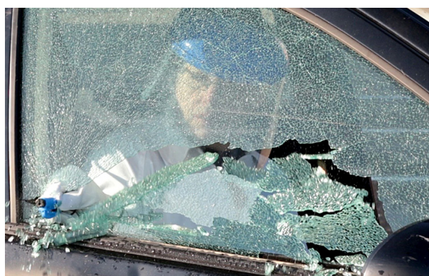
Imagen 7. Pruebas realizadas por Centro Zaragoza. Disponer de un percutor o de un martillo de rotura de ventanillas hará mucho más fácil y rápida esta operación en caso de ser necesaria. Fuente: Centro Zaragoza.
