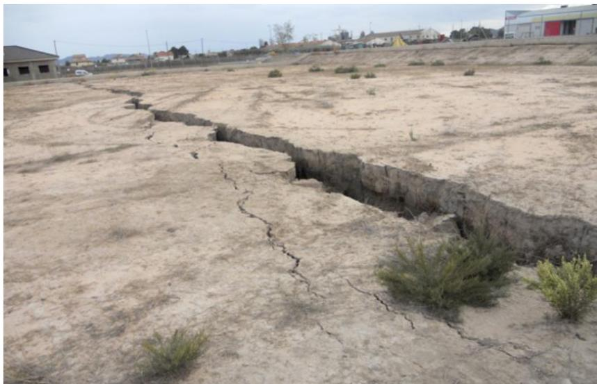
Figura 9. Fenómeno de tubificación en el paraje de Los Soles de La Estación de Puerto Lumbreras.
