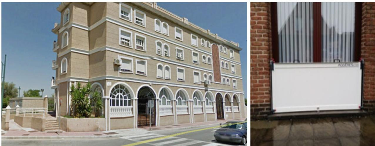
Figura 7. Edificio de viviendas adaptado a las inundaciones, en el que se han elevado los umbrales de puertas y ventanas a través de los cuales podría penetrar el agua. Guadalmar (Málaga).
