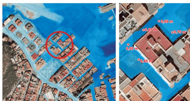
Figura 1. Datos de alturas de agua en zona perimetral de un edificio tipo.
