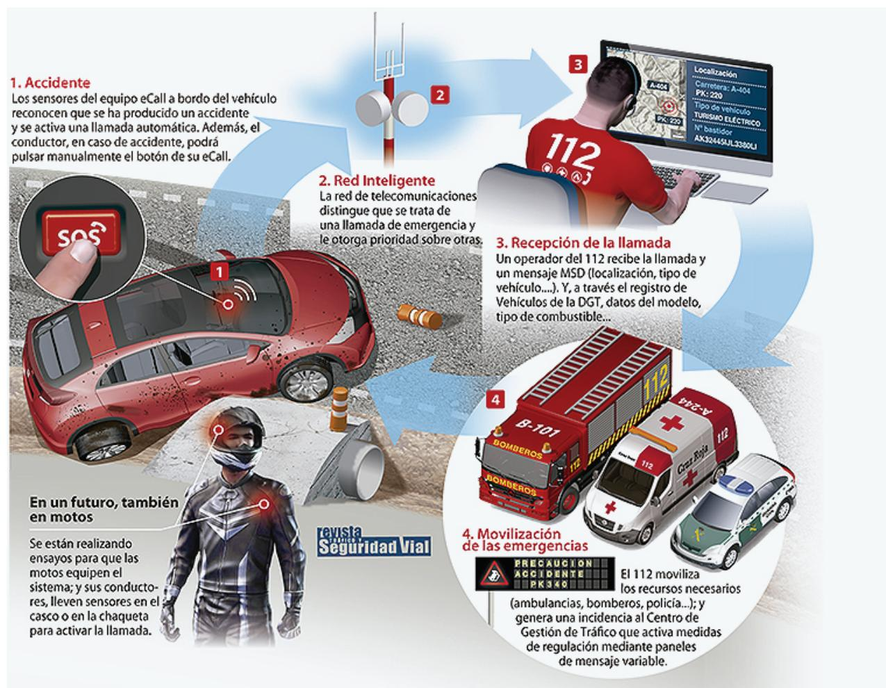
Figura 1. Esquema de funcionamiento de los dispositivos eCall.
