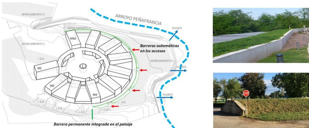
Figura 18. Caso piloto en Gijón: esquema resumen de la alternativa 2. Detalle: ejemplos de barreras permanentes integradas en el paisaje.
